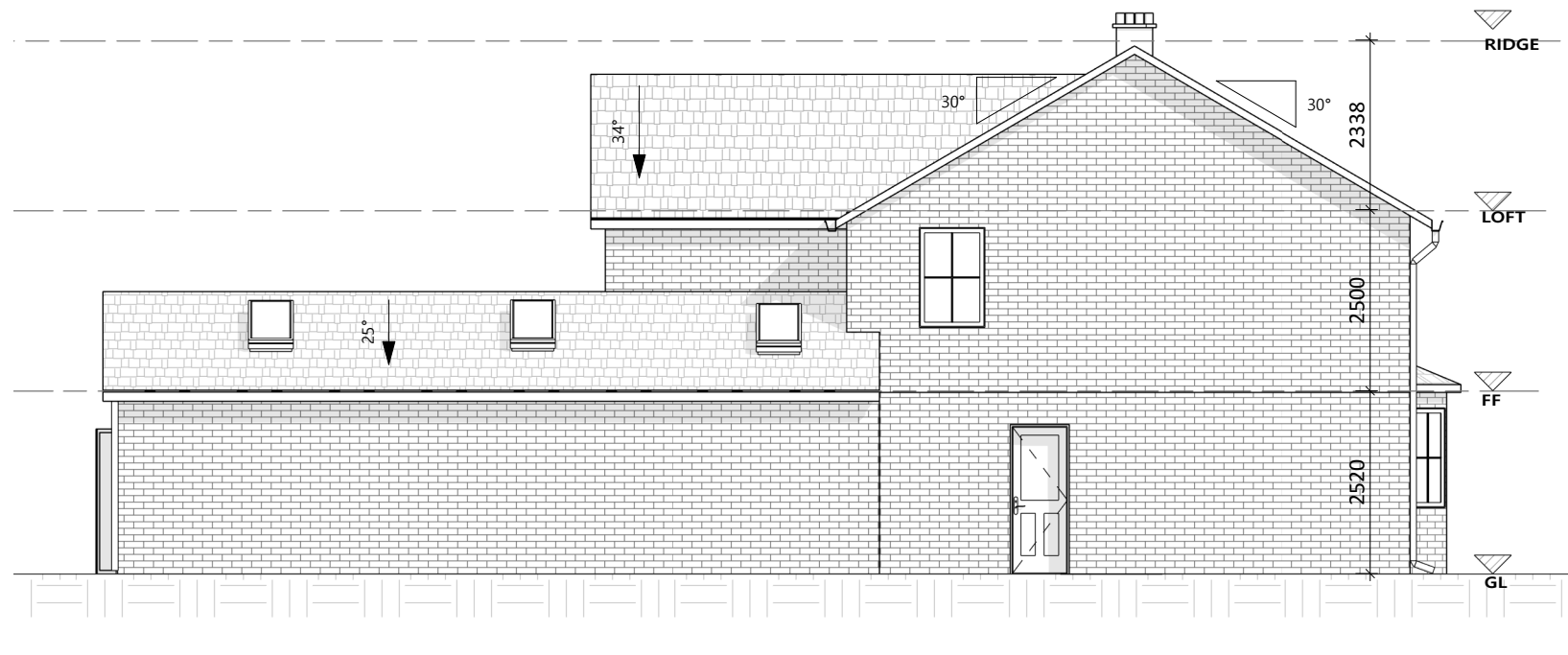
PR-LEFT ELEVATION 1 : 100 @A1; 1:200 @A3
